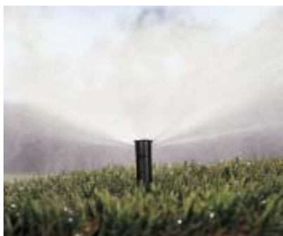
Ohne Druckregulierung Feiner Sprühnebel, das Wasser wird weggetragen
